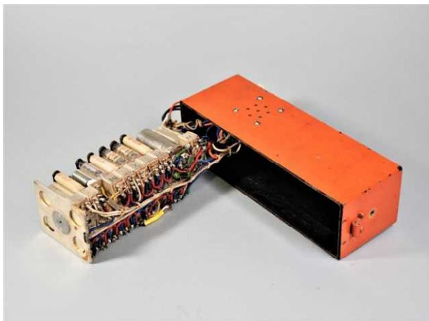
図5 高所移動用小型通信機のブロック回路構成と外部筐体
