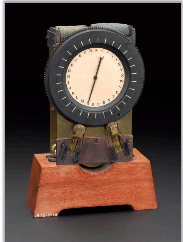
1840年にクックとホイートストーンによって発明された指字ダイアル式電信機の送信機(左)と受信機(右) 送信機表面に文字盤があり、所定の位置に送りたい文字が来るように文字盤を回転する。文字盤の下を見ると、1文字おきに導通・被導通を繰り返す金属パターンが張られていて、文字盤の回転に伴って電流がON、OFFされる。受信側では送られてきたパルスのON、OFFに脱進器(Escapement Wheel)が同期して指字針が回転する。脱進器についてはシート番号25を参照されたい。
