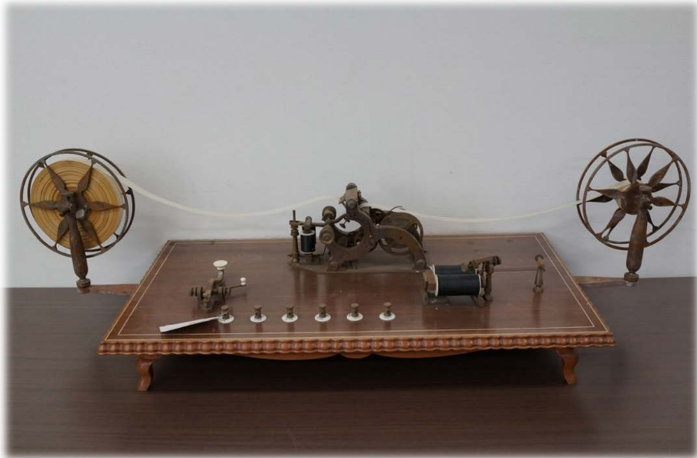
1854年にペリー提督が献上したエンボス式モース電信機 (左)全体、(右上)ラクダ型電鍵、(右下)エンボッシングレジスタ
