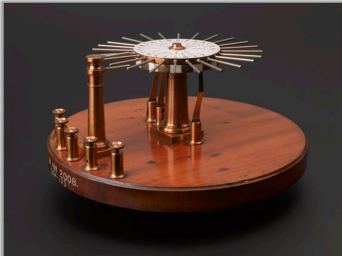
1840年にクックとホイートストーンによって発明された指字ダイアル式電信機の送信機(左)と受信機(右) 送信機表面に文字盤があり、所定の位置に送りたい文字が来るように文字盤を回転する。文字盤の下を見ると、1文字おきに導通・被導通を繰り返す金属パターンが張られていて、文字盤の回転に伴って電流がON、OFFされる。受信側では送られてきたパルスのON、OFFに脱進器(Escapement Wheel)が同期して指字針が回転する。脱進器についてはシート番号25を参照されたい。
