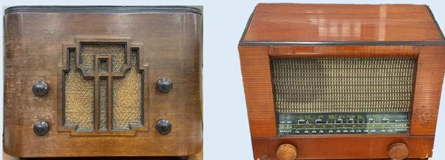
(左) 三田無線電話研究所が昭和11(1936)年ころに製造販売したラジオ。形式は45型。周波数変換2A7、中間周波増幅5B8、検波と低周波増幅2B7、電力増幅2A5、整流80、のいわゆる5球スーパーヘテロダイナラジオ。中波と短波を切り替えて受信できる。放送局を選局するバリコンはありチューニングはできるが、どこにもダイヤルが無いのが不思議。実測では標準的な中波放送帯と短波帯(6～16MHz)をカバーしている。
